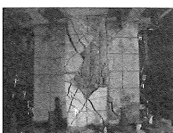
超強度繊維補強コンクリートを用いた袖壁による柱の補強実験
