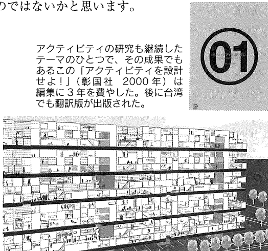
「ハノイモデル」と平行して設計した「スペースブロック・東京モデル」は、構造の専門家とのコラボレーションで水平免震ダンパーとコンピュータ制御のダブルジャロジーを装備した設計。1:10模型で振動実験を行った。日本建築学会設計競技1等案。
